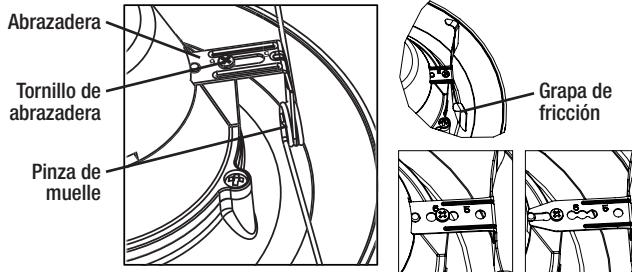
**5** Si la carcasa tiene orejas, use las pinzas de muelle. El ajuste de fábrica de las pinzas de muelle es para una carcasa de 6 pulg. Ajuste las pinzas de muelle aflojando los tornillos. Apriete los tornillos una vez que las pinzas estén en su lugar.
