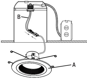
**7** Conecte el conector de cables del adaptador para portalámpara de base media (E26) al conector de cables de la lámpara.
