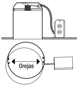
**4** Determine si el interior de la carcasa tiene orejas o no.
