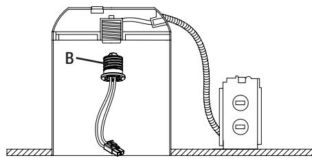
**6** Enrosque el adaptador para portalámpara de base media (E26) en el portalámpara de la carcasa empotrada.
