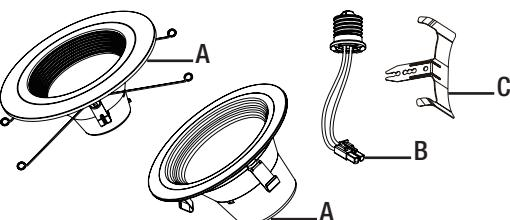
**6** Vissez l'adaptateur de douille pour culot moyen (E26) dans la douille du boîtier encastré.
