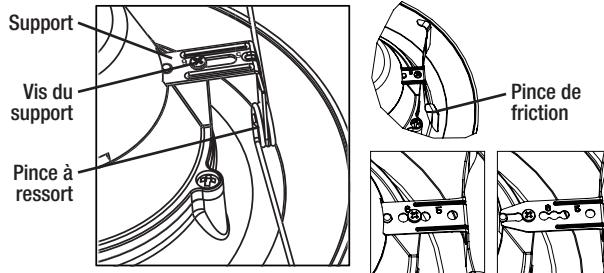
**5** S'il y a des oreilles, utilisez les pinces à ressort. Les pinces à ressort sont réglées à l'usine pour un boîtier encastré de 15,24 cm. Ajustez les pinces à ressort en desserrant les vis. Resserrez les vis une fois les pinces à ressort en place.
