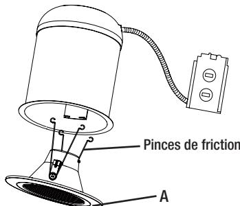
**7** Branchez le connecteur de l'adaptateur à douille moyenne (E26) au connecteur de la lampe.
