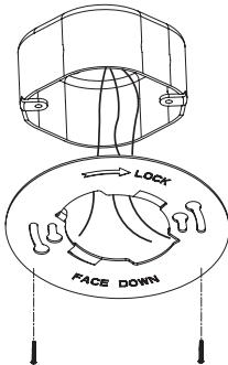
**4b** Para montaje en superficie: Fije la placa de montaje a la caja de conexiones.
