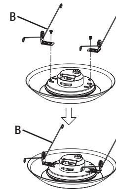
**4a** Instalación en una carcasa empotrada: Fije los clips de resorte a la lámpara.
