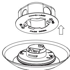
**6b** Fije la lámpara a la placa de montaje insertando la lámpara en los agujeros oblongos de la placa de montaje y girando la lámpara hasta que esté segura.
