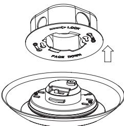
**6b** Fixer la lampe à la plaque de montage en insérant la lampe dans les trous oblongs de la plaque de montage et tournant jusqu'à ce que la lampe soit retenue.
