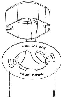
**4b** Montage en surface : Fixez la plaque de montage à la boîte électrique.
