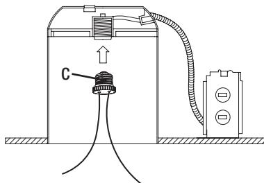
**5a** Enrosque el adaptador para portalámpara de base media (E26) en el portalámpara de la carcasa empotrada.
