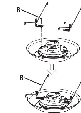
**4a** Installation dans un boîtier encastré : Attachez les pinces à ressort à la lampe.
