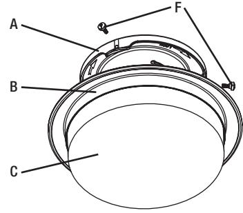
**11** Añade los 3 tornillos del difusor en los 3 orificios de la placa de fijación. Asegúrese de que la lámpara y el difusor estén seguros.
