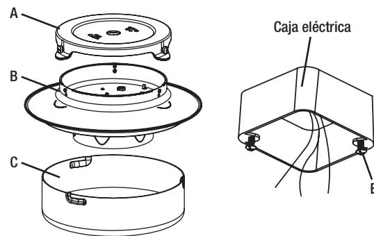
**4** Separe el difusor y la lámpara de la placa de fijación.
