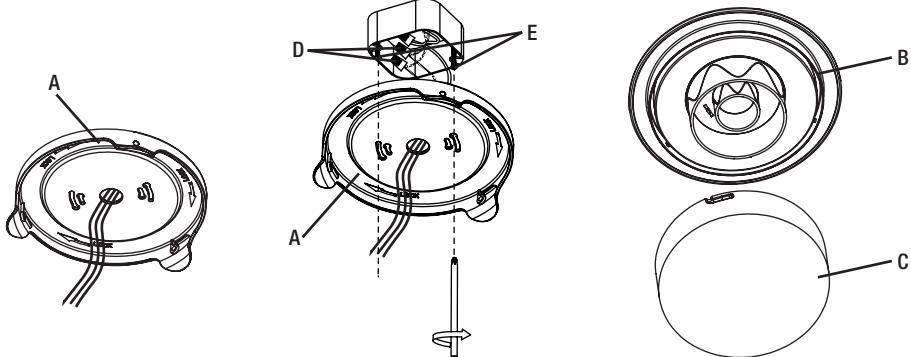
**6** Pase los cables desde la lámpara a través de la placa de fijación.
